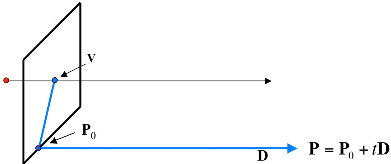
$$\mathbf{P}_t = \begin{bmatrix} P_X + tD_X \\ P_Y + tD_Y \\ P_Z + tD_Z \\ 1 \end{bmatrix} \cong \begin{bmatrix} P_X / t + D_X \\ P_Y / t + D_Y \\ P_Z / t + D_Z \\ 1/t \end{bmatrix} \quad t \rightarrow \infty \quad \mathbf{P}_\infty \cong \begin{bmatrix} D_X \\ D_Y \\ D_Z \\ 0 \end{bmatrix}$$
