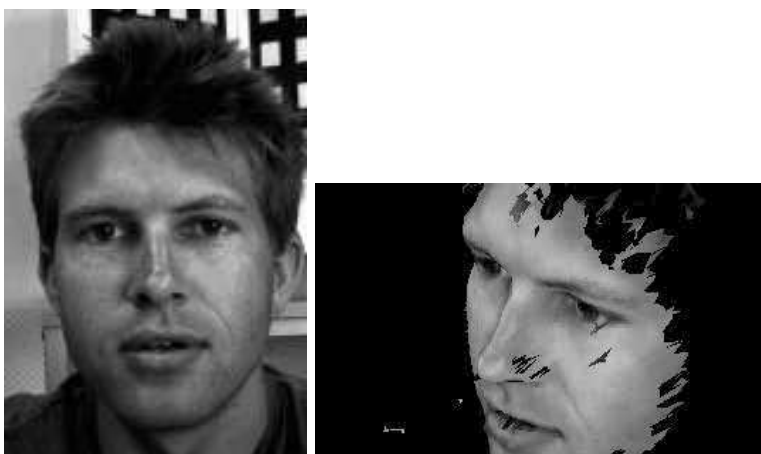
FIG. 7 – Niveau 5 : stéréovision. Nécessite la géométrie de deux caméras et des techniques de mise en correspondance.
